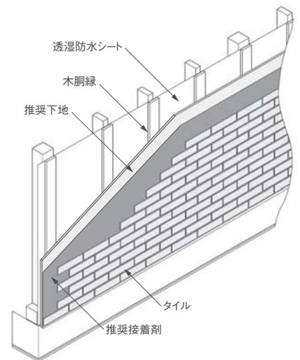
※施工中にタイル裏面を確認し、接着剤付着面積が60%以上あるか確認してください。ない場合は塗布量を増やしてください。
